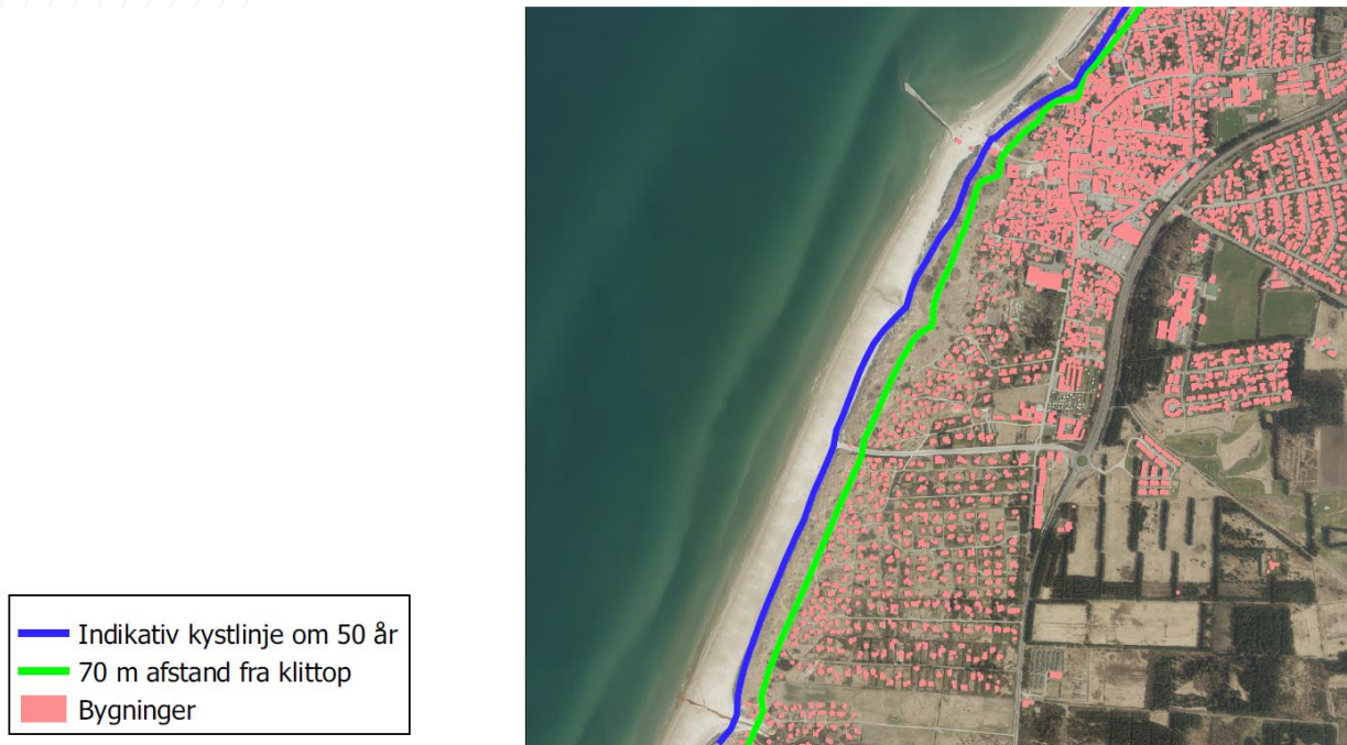
Figur 10.2 Fremskrivning af kronisk erosion i 50 år (blå) og 70m zone fra toppen af skråningen (grøn) sydvest for Løkken Mole, Bilag D
