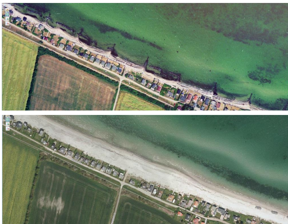
Figur 13.1: Før (1992 øverst) og efter (2012 nederst) fotos af nordlige del af den ca. 13 km lange strandfodrede kyststrækning, mellem Egebjerggård og Erikshåb på Nordfyn
