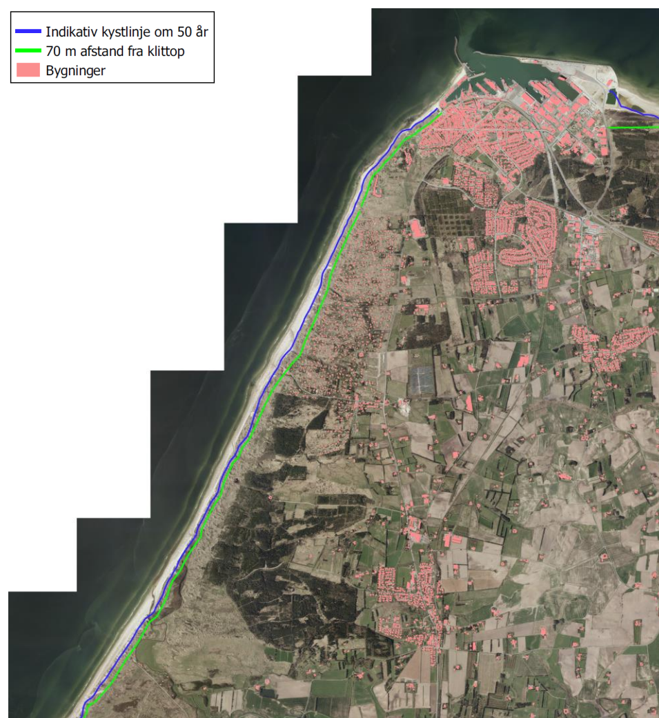
Figur 10.10 Fremskrivning af kronisk erosion i 50 år (blå) og 70m zone fra toppen af skråningen (grøn) mellem Nørlev Strand og Hirtshals, Bilag D
