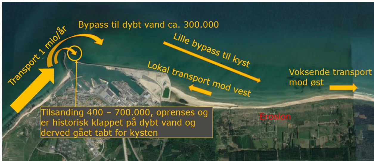
Figur 7.7 Sedimentations forhold ved Hirtshals Havn
