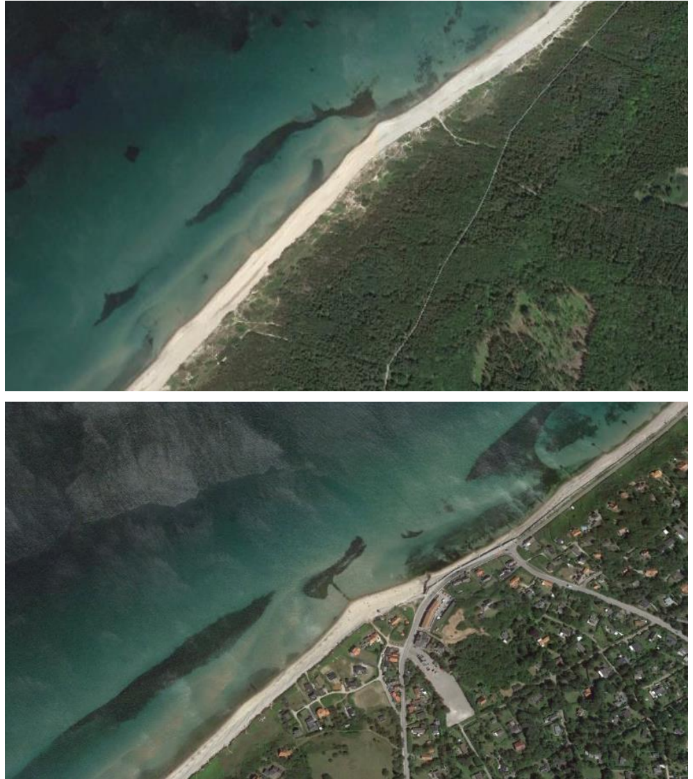
Figur 12.16: Naturligt stenrev på Nordkysten ved Stængehage (øverst) og den ødelagte bølgebryder i Rågeleje (nederst)
